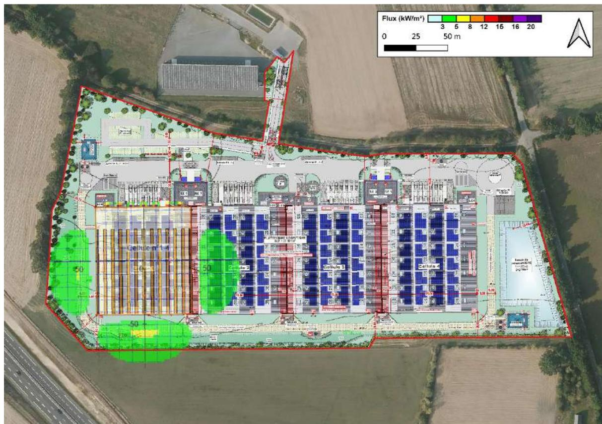
Figure 8 : Flux thermiques perceptibles à l'intérieur du site en cas d'incendie de la cellule 1 (palette-type 1510)
