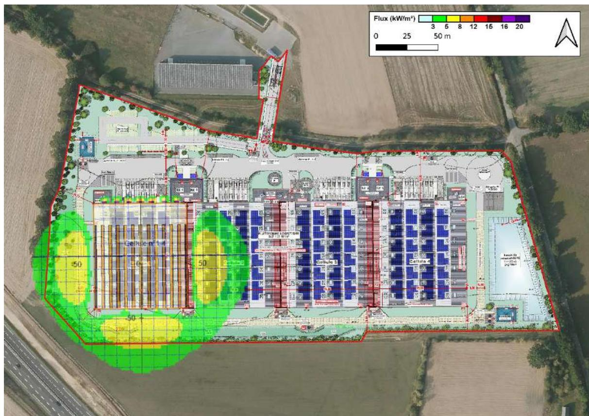
Figure 14 : Flux thermiques perceptibles à l'intérieur du site en cas d'incendie de la cellule 1 (palette-type 2662-2663)
